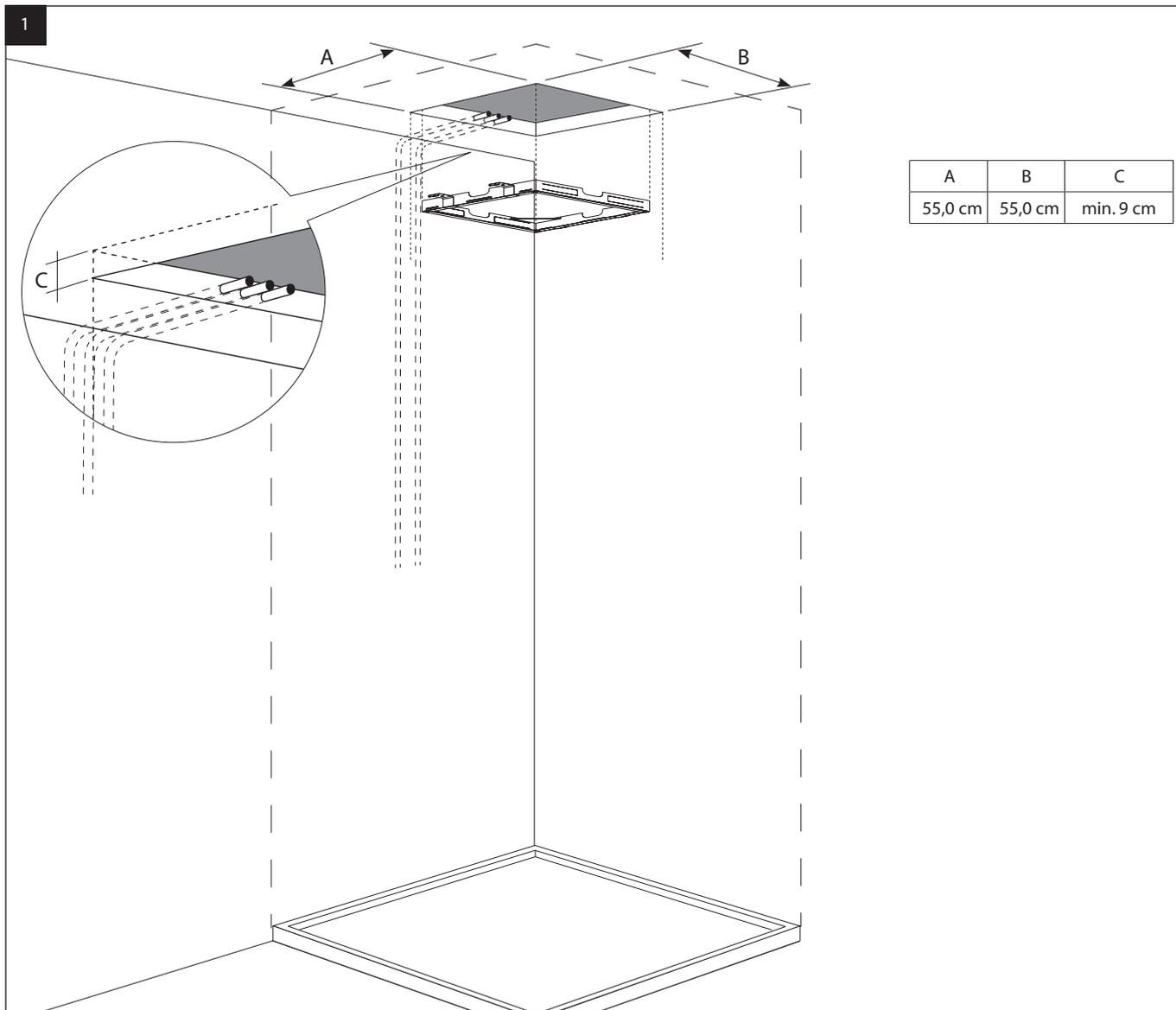
IT - Per l'installazione su controsoffittatura, consultare le istruzioni relative al kit fissaggio di sicurezza
