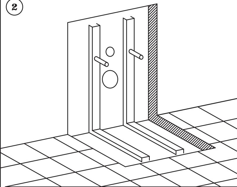
**I** Praticare uno scasso sulla parete e sul pavimento per posizionare le staffe a "L" per l'ancoraggio del sanitario. Seguire le istruzioni del kit di fissaggio.
