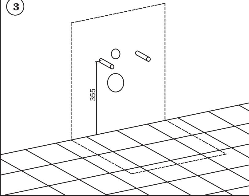
**I** Rifinire il pavimento e la parete lasciando scoperti i perni per l'ancoraggio del sanitario. Posizionare i sanitario e stringere le viti di fissaggio.
